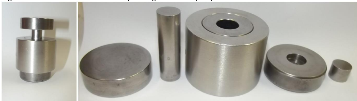
Figura 13 – Pastilhador utilizado na prensagem dos corpos poliméricos
