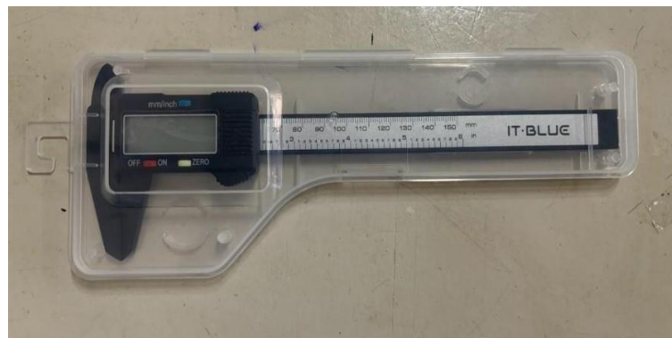
Figura 3-Equipamento paquímetro digital It. Blue utilizado nas avaliações.
