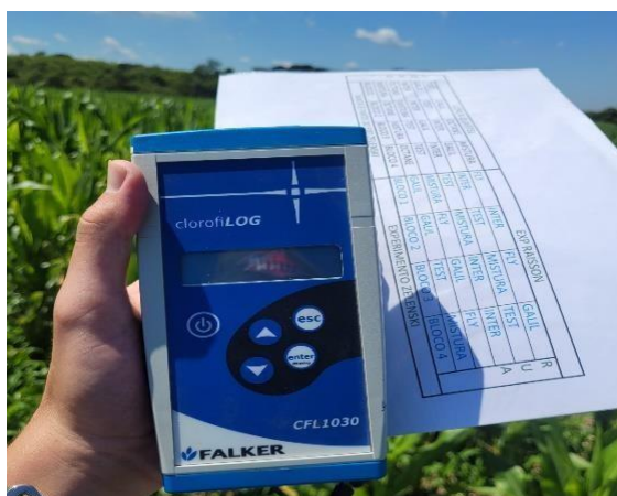
Figura 2- Clorofilômetro digital da marca Falker.
