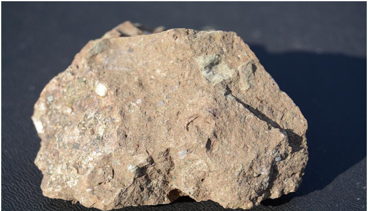
FIGURA 34: Amostra de brecha polimítica originada com o impacto em Vista Alegre. A dimensão maior é de cerca de 15cm.
