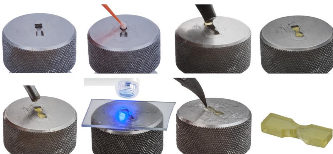
Figura 8. Confecção de corpos de prova de adesivo (CPA), para teste de resistência máxima à tração Fonte: O autor.
