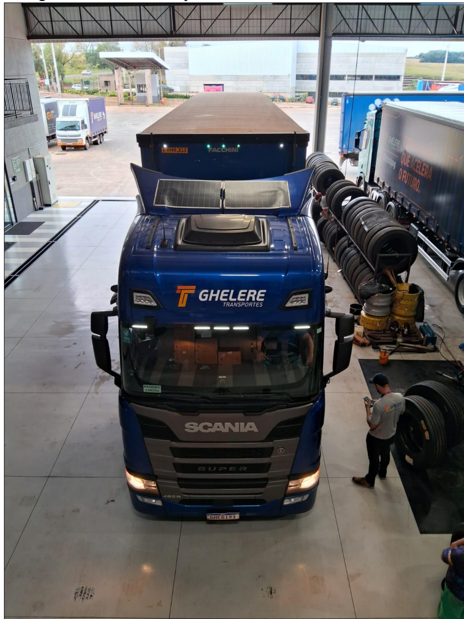
Figura 38 – Placa solar que melhora a vida útil da bateria – 2025
