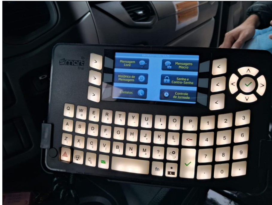
Figura 37 – Teclado com conexão via satélite instalado na cabine dos caminhões – 2025
