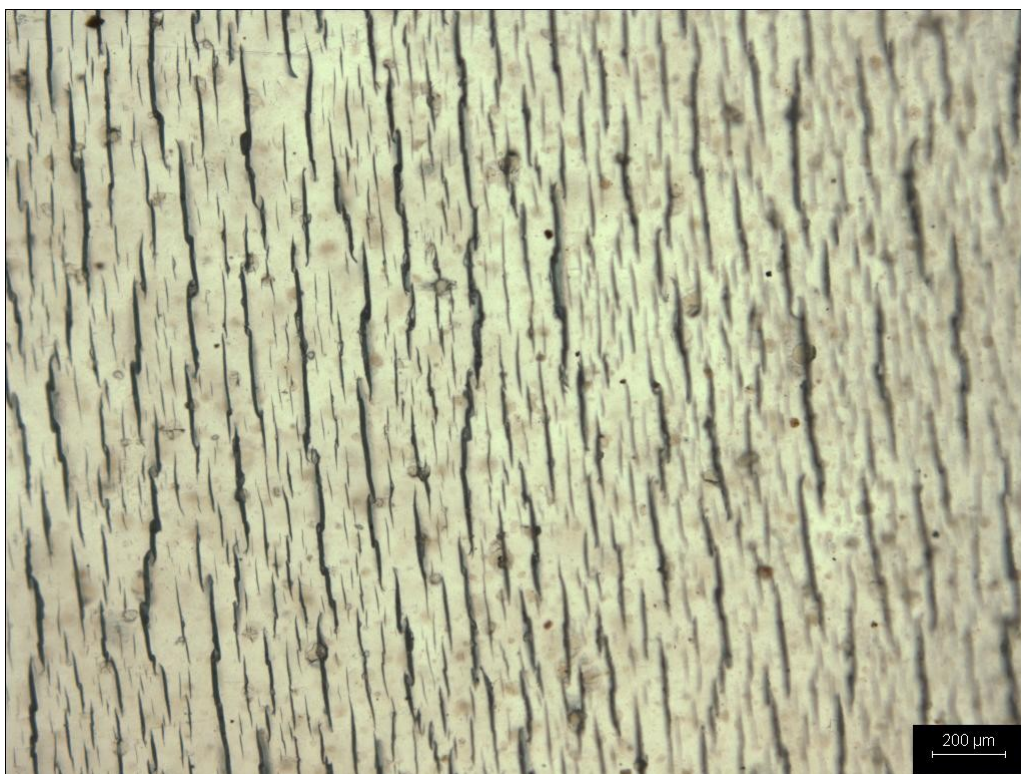
Figura 4.24 – Micrografia da amostra de CBP após exposição UV durante 240 horas.
