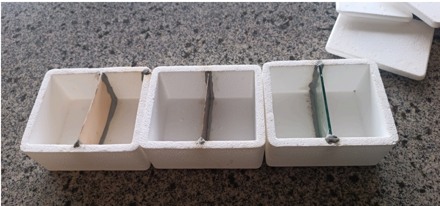
Figura 16: Fotografia de calorímetros adaptados para o experimento de condução.
