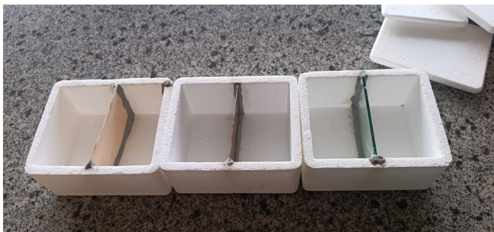
Figura 3.8 - Calorímetros adaptados para o experimento de condução.
