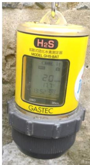
Figura 5.5 – Detector portátil de gás sulfídrico de 0 a 1000 ppm
