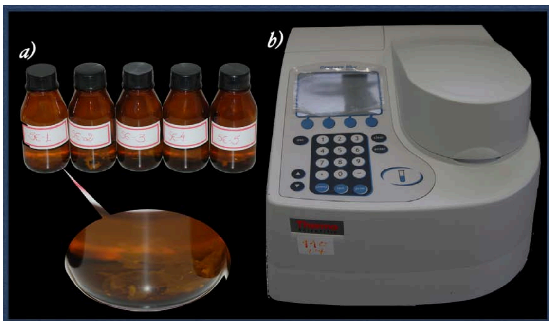
Figura 5. Teste de liberação do polímero quaternário de amônio dos sistemas adesivos. a) Pesagem de 0,05 g de cada sistema adesivo por frasco âmbar contendo 20 mL de saliva artificial. b) Espectrofotômetro Thermo UV-Vis (Genesys 10S) utilizando cubetas de vidro de 1cm -1 de caminho óptico, com leitura em \lambda = 640 nm.
