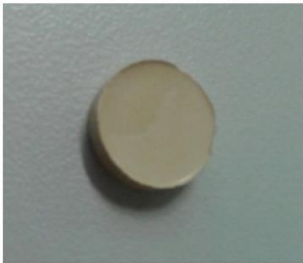
Figura 11. Pastilhas de 8,0 mm de diâmetro por 2,0 mm de altura utilizadas para imobilização dos catalisadores.
