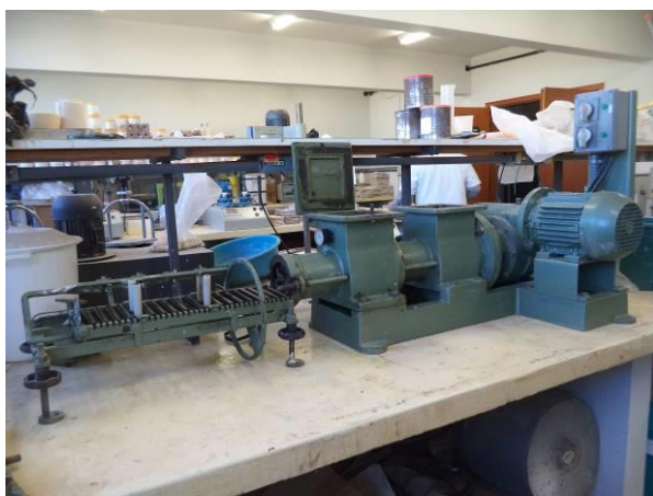
Figura 3.3(a) e 3.3 (b) – Extrusora de bancada e molde em forma de barrinhas.
