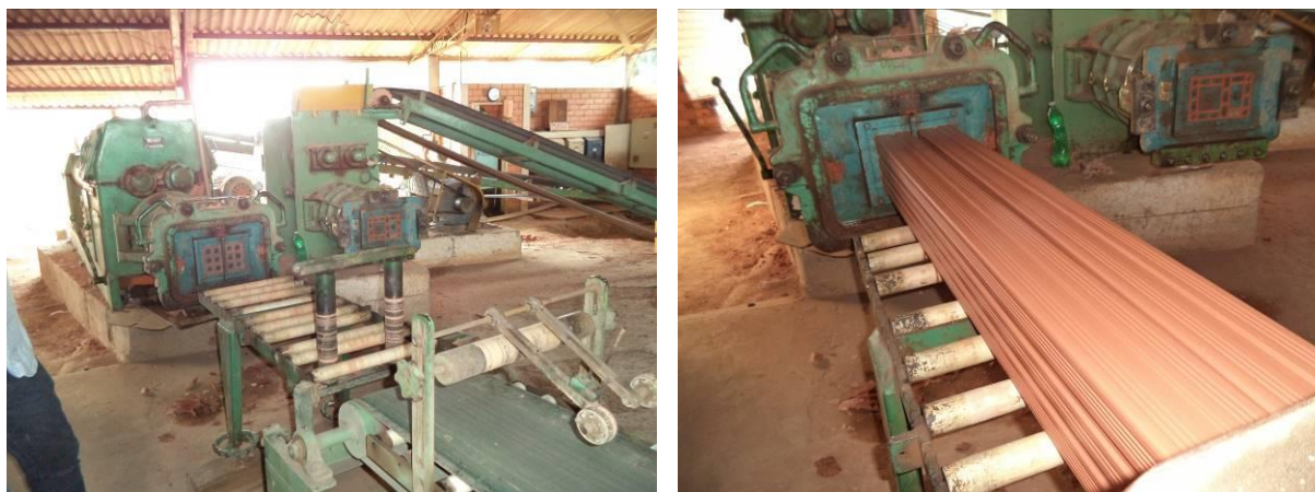
Figura 2.12 (a) e 2.12 (b) – Extrusora sendo utilizada para a fabricação de blocos cerâmicos vazados.
