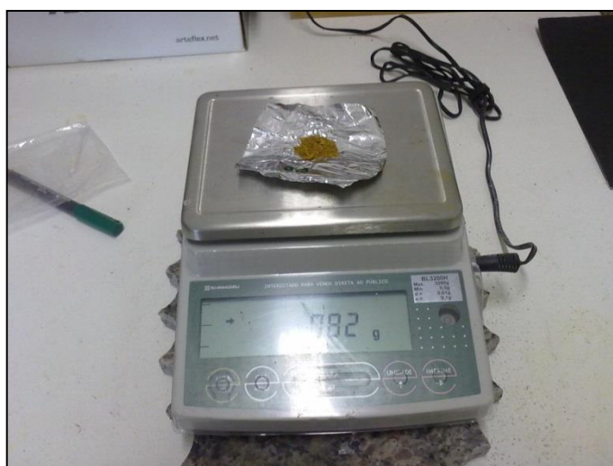
Figura 14: Balança usada para pesagem do pó separado para as pastilhas.
