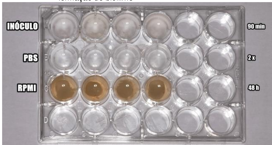
FIGURA 8 – Dispositivos imersos no meio de cultura após período de formação de biofilme
