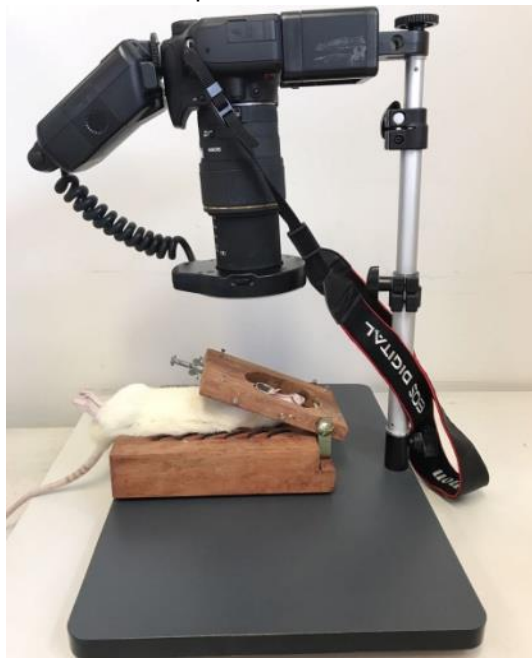
FIGURA 12 - Posicionamento dos animais em maca estabilizadora e utilização de mesa estativa para obtenção de fotografias padronizadas
