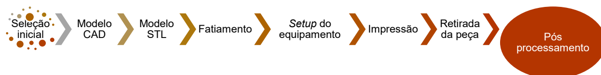
Figura 14 - Etapas de fabricação por manufatura aditiva
