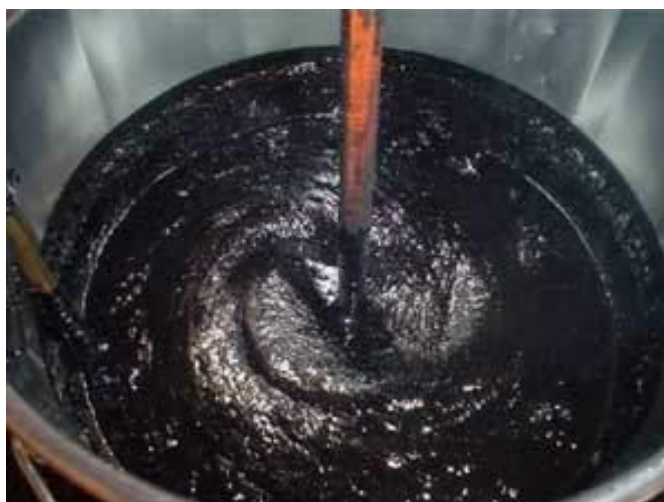
Figura 2.11: Cimento asfáltico modificado com resíduo de pneu.
