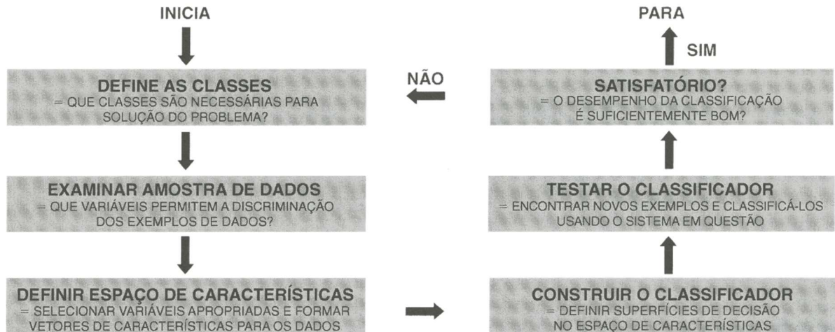
Figura 14 – Fluxograma representando os principais passos no projeto de um classificador.
