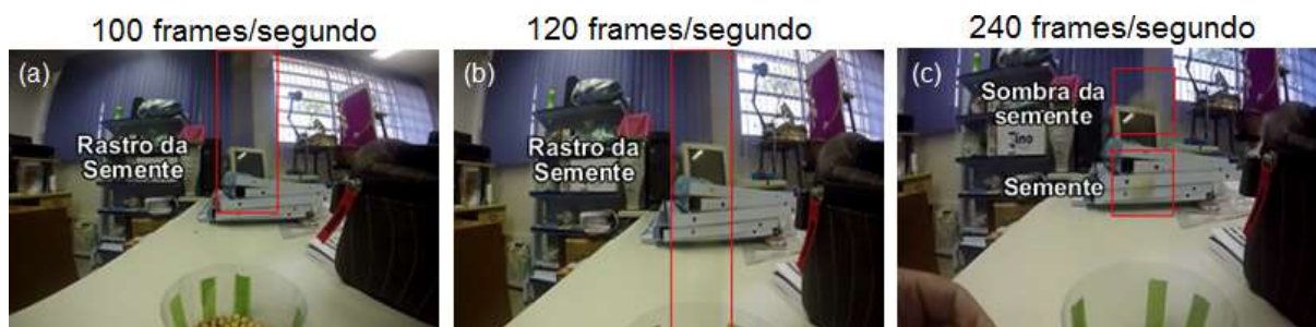
Figura 47 - Experimento de captura de vídeo com uma câmera GoPro configurada em: (a) 100 frames/segundo; (b) 120 frames/segundo; (c) 240 frames/segundo.
