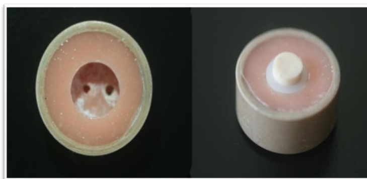
Figura 14- Dispositivo para adaptação do corpo-de-prova e fixação na matriz da máquina de escovação
