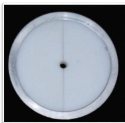
Figura 16- Molde para a confecção dos corpos-de-prova para a avaliação da resistência à compressão
