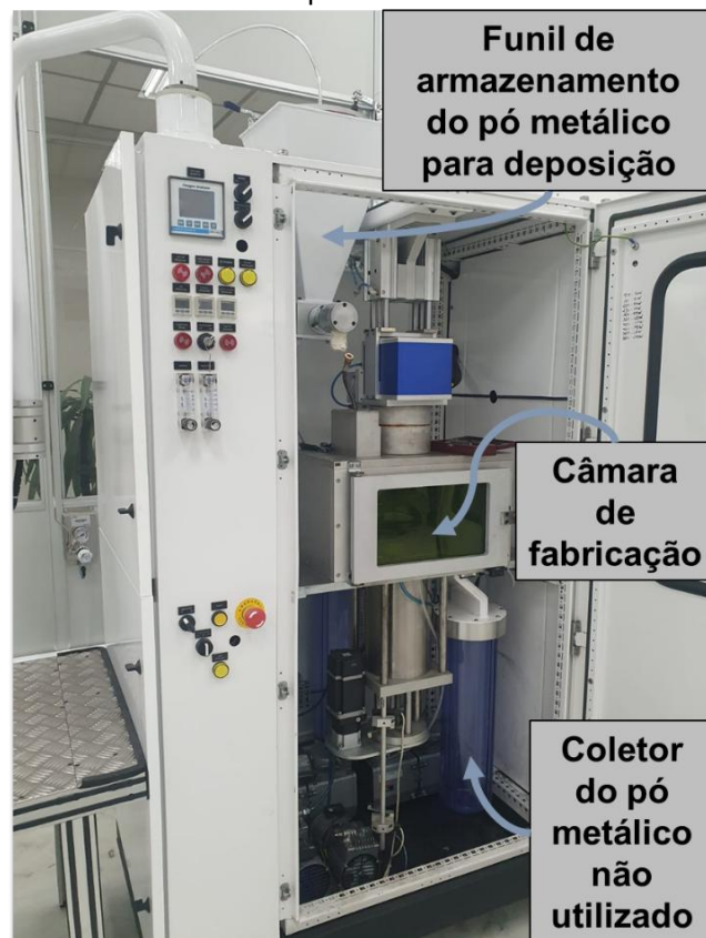
Figura 30 – Equipamento de fusão em leito de pó a laser OmniSint 160.
