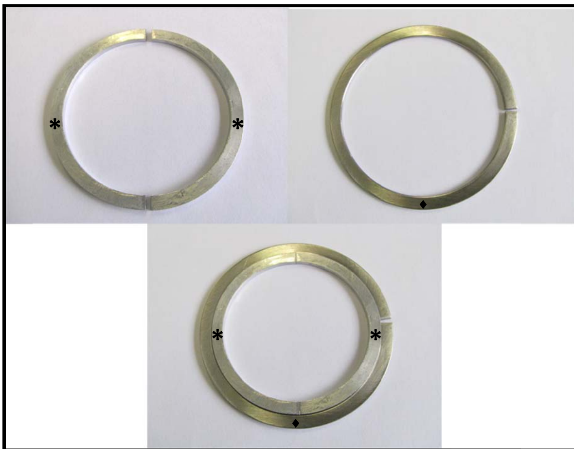
FIGURA 6 – Matrizes metálicas para confecção dos corpos de prova das análises de liberação
