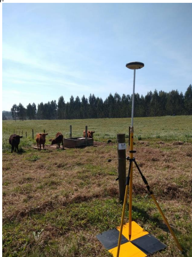
Figura 6 – Receptor GNSS Spectro SP60 sobre uma GCP coletando dados com a cultura da soja ( Glycine max ).
