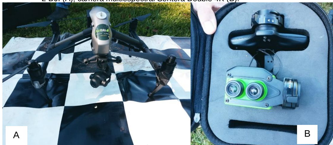
Figura 5 – Equipamentos para coleta de imagens aéreas na cultura da soja ( Glycine max ). RPA Inspire 2 DJI (A); câmera multiespectral Sentera Double 4K (B).
