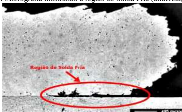
Figura 3.5. Micrografia mostrando a região de Solda Fria ( undercut , Cold Lap ).
