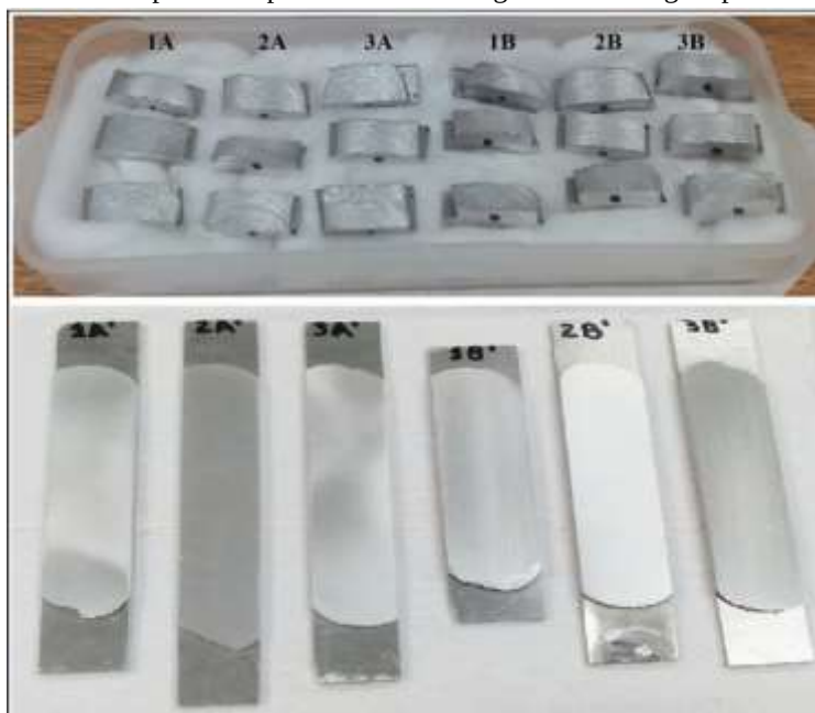
Figura 4.4. Amostras obtidas após corte para análise metalográfica e usinagem para ensaio de dobramento.
