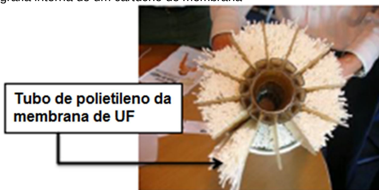
Figura 3.4 - Fotografia interna de um cartucho de membrana
