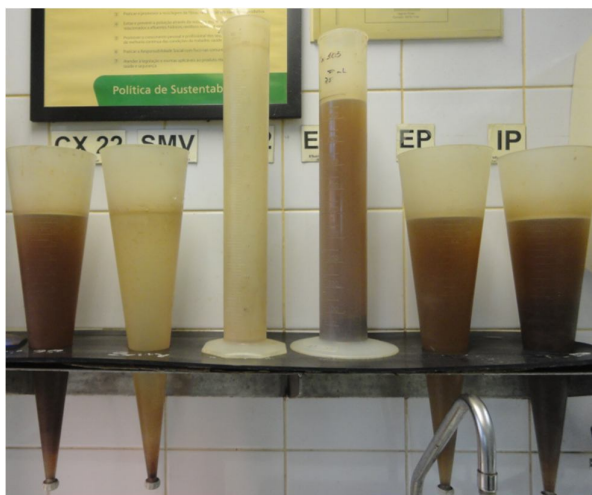
Figura 4.6 – Ensaio de sólidos sedimentáveis utilizando cones de Imhoff.
