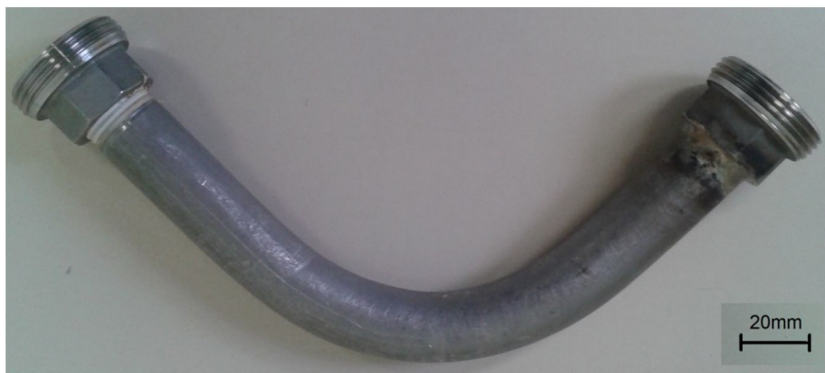
Figura 4.3 - Cotovelo de aço 316L usado para teste de corrosão dinâmico
