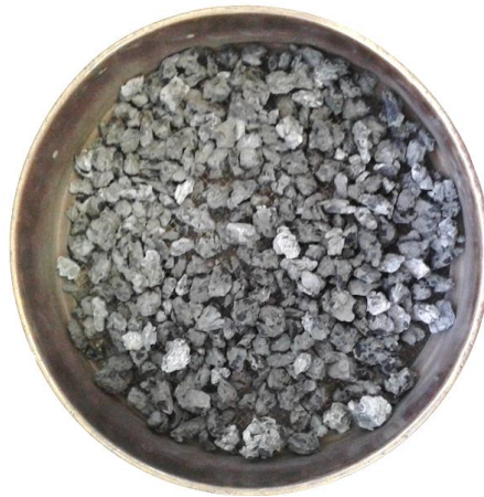
Figura 34 – Amostra utilizada no ensaio de determinação da absorção da pasta de cimento
