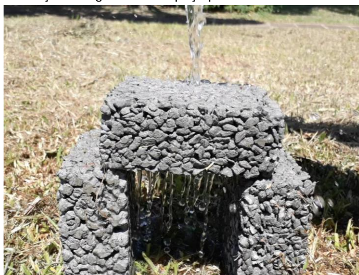
Figura 1 – Infiltração de água em uma peça pré-moldada de concreto permeável
