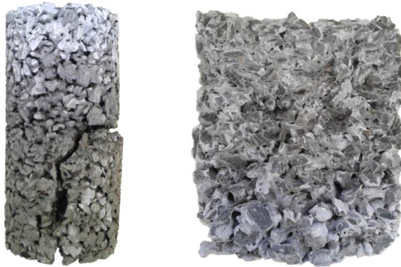
Figura 28 – Modo de ruptura à tração indireta e seção de fratura do concreto g/c-3,10 compactado com 2 camadas
