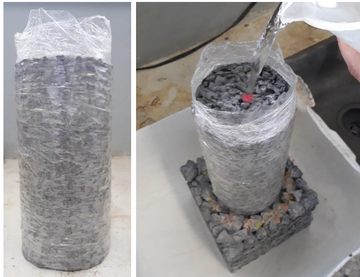
Figura 8 – Vedação lateral da amostra de concreto permeável e execução do ensaio para determinação da taxa de infiltração
