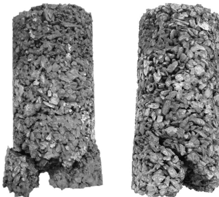
Figura 32 – Modo de ruptura à tração por compressão diametral das amostras compactadas com 3 camadas
