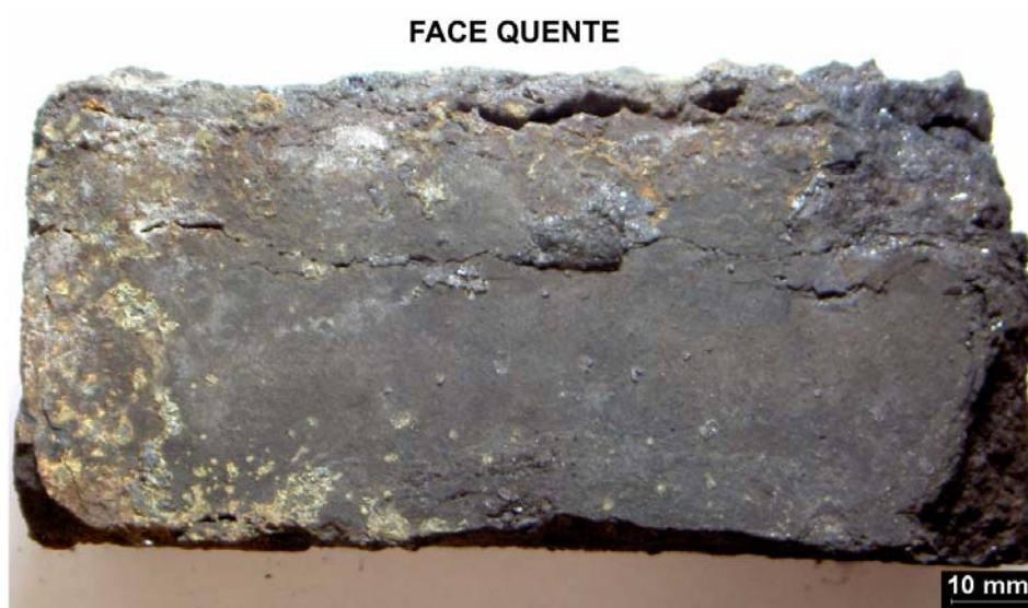
Figura 1 Aspecto visual do refratário formado de magnésia-cromo “M2” após utilização em forno rotativo de redução de chumbo secundário.
