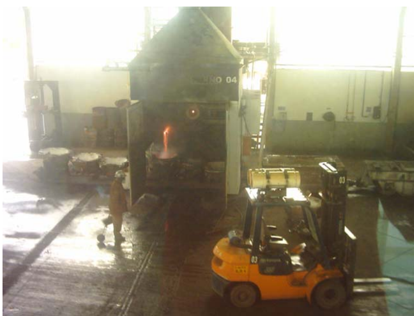
Figura 1.3 Vazamento de escória.
