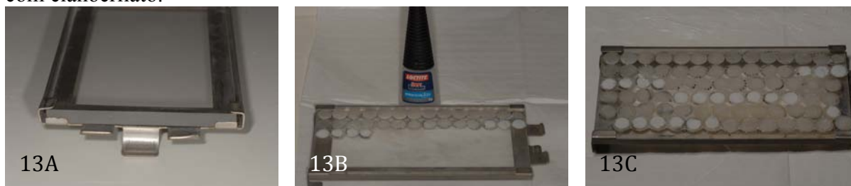
Figuras 13A-13C: Placa de acrílico acoplado ao suporte metálico onde os cp foram fixados com cianocrilato.
