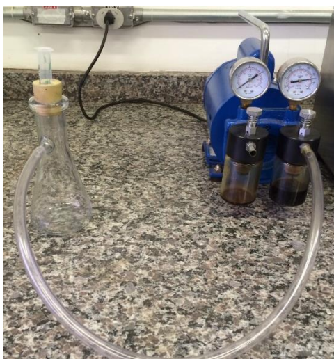
FIGURA 188: EQUIPAMENTO UTILIZADO PARA AS ETAPAS DE PRÉ-CONCENTRAÇÃO E ELUIÇÃO DO ANALITO
