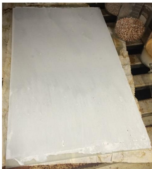
FIGURA 155: TiO 2 IMOBILIZADO NA SUPERFÍCIE
