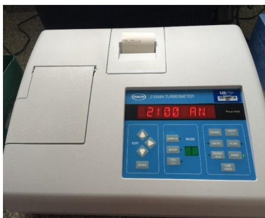
FIGURA 11: EQUIPAMENTOS UTILIZADOS PARA LEITURAS DE TURBIDEZ E COR
