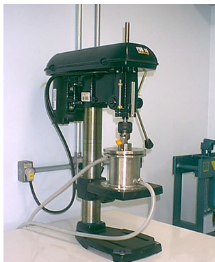
FIGURA 6 - MOINHO DE ATRITO DO LABORATÓRIO DA UNIVAP
