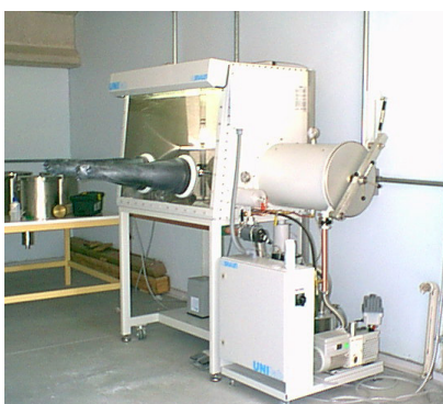
FIGURA 13 - DRY BOX UTILIZADA PARA A MANIPULAÇÃO DOS PÓS Ti, Nb, NbH E Sn, VISANDO A PREPARAÇÃO DAS LIGAS Ti-Nb-Sn, LOCALIZADA NA UNIVAP.
