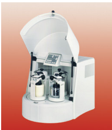
FIGURA 7 - MOINHO DE BOLAS PLANETÁRIO PULVERISETTE 5 DA FRITSCH LOCALIZADO NA UNIVAP
