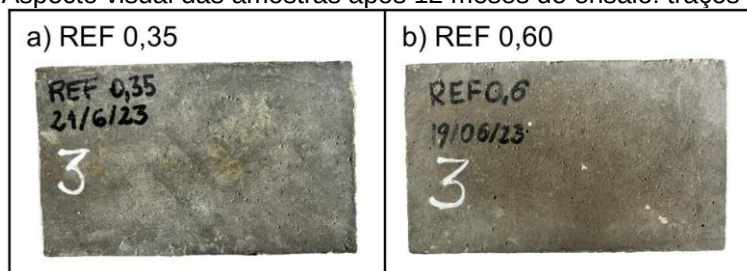
Figura 47 – Aspecto visual das amostras após 12 meses de ensaio: traços de referência.
