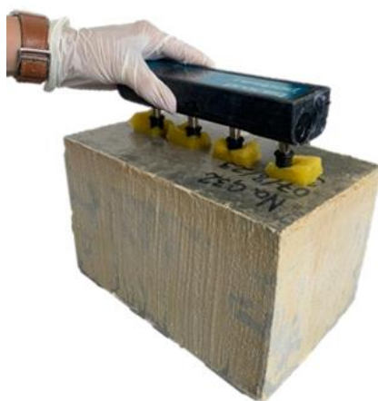
Figura 35 - Leitura da resistividade elétrica superficial nos corpos de prova.
