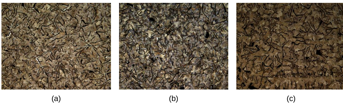
Figura 66 – Microscopia óptica, aumento de 100x, ataque com nital a 2%: a) microestrutura de amostra com adição de 0,2% Ni; b) microestrutura de amostra com adição de 0,4% Ni; e c) microestrutura de amostra com adição de 0,5% Ni.
