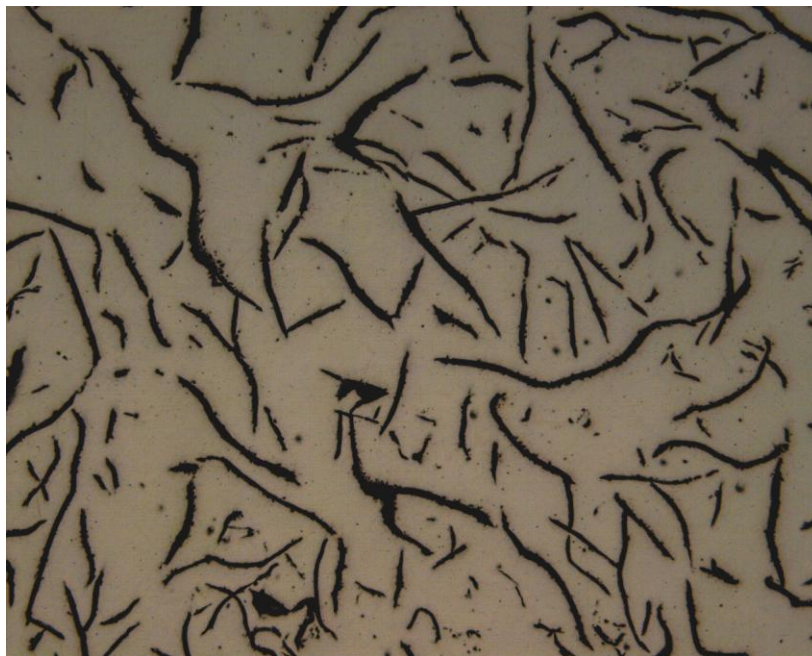
Figura 67 – Nota-se a presença de grafitas degeneradas com aumento de 200x, sem ataque.
