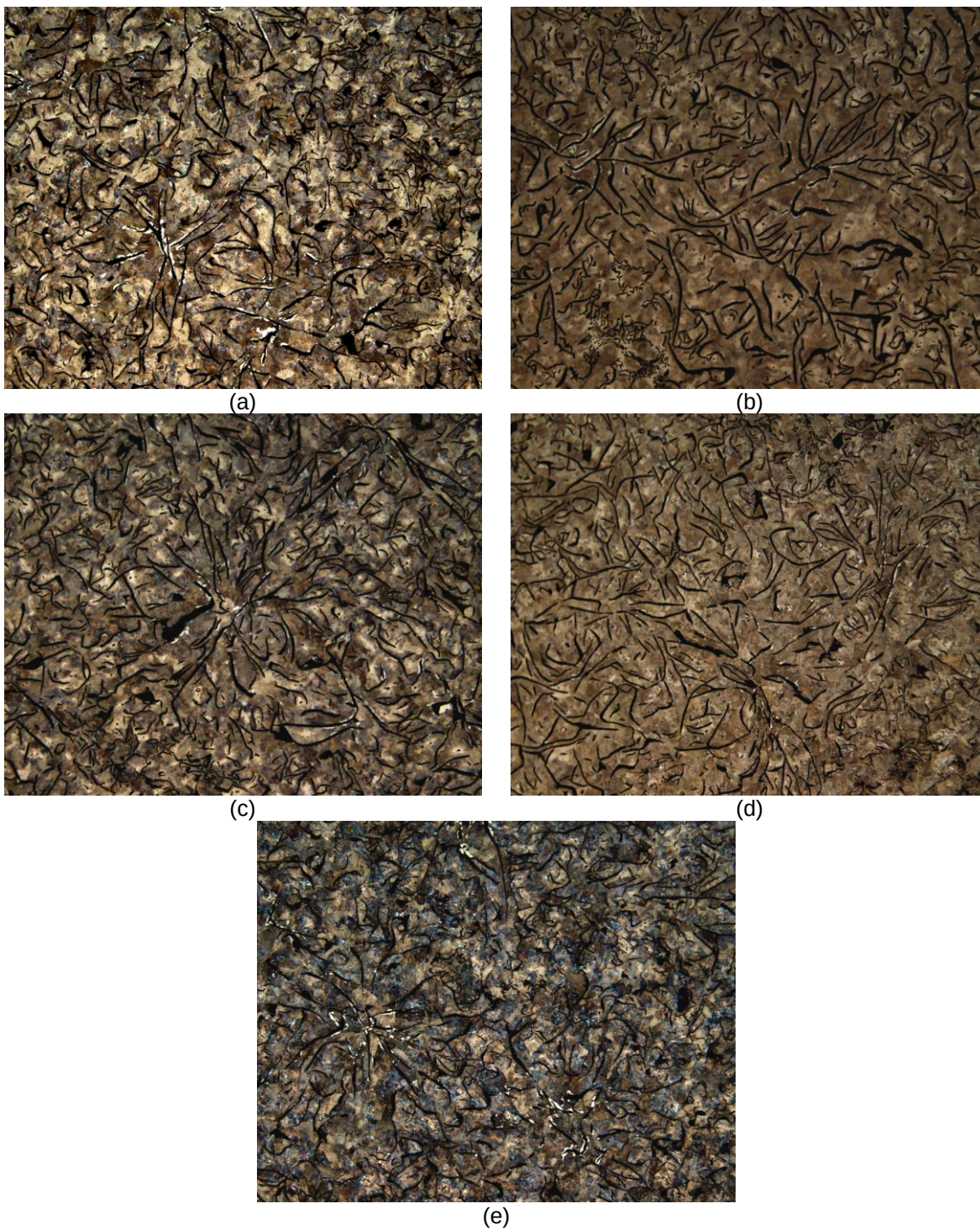
Figura 72 – Microscopia óptica, aumento de 100x, ataque com nital a 2%: a) microestrutura de amostra com adição de 0,05% Si; b) microestrutura de amostra com adição de 0,08% Si; c) microestrutura de amostra com adição de 0,1% Si; d) microestrutura de amostra com adição de 0,2% Si; e e) microestrutura de amostra com adição de 0,4% Si.
