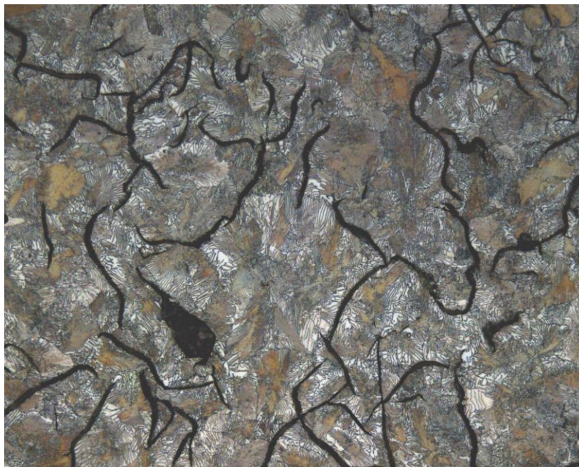
Figura 77 – Microestrutura de amostra com adição de 0,2% Sn. Microscopia óptica, aumento de 500x, ataque com nital a 2%.
