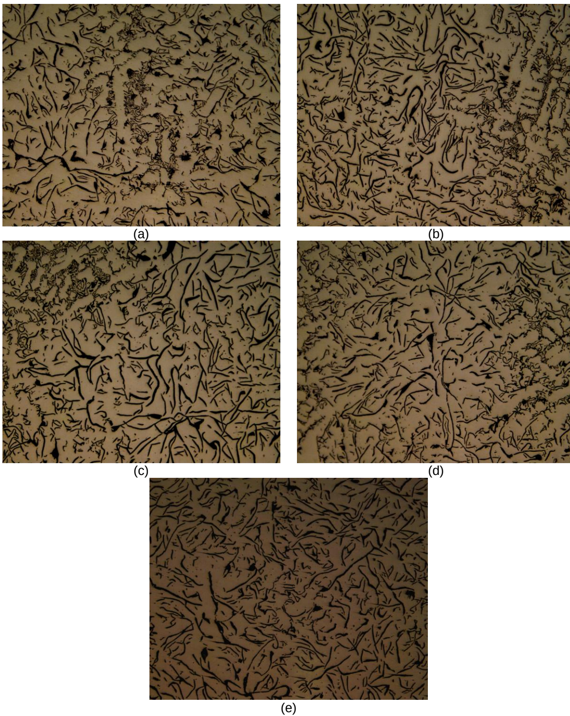
Figura 71 – Microscopia óptica, aumento de 100x, sem ataque: a) microestrutura de amostra com adição de 0,05% Si; b) microestrutura de amostra com adição de 0,08% Si; c) microestrutura de amostra com adição de 0,1% Si; d) microestrutura de amostra com adição de 0,2% Si; e e) microestrutura de amostra com adição de 0,4% Si.
