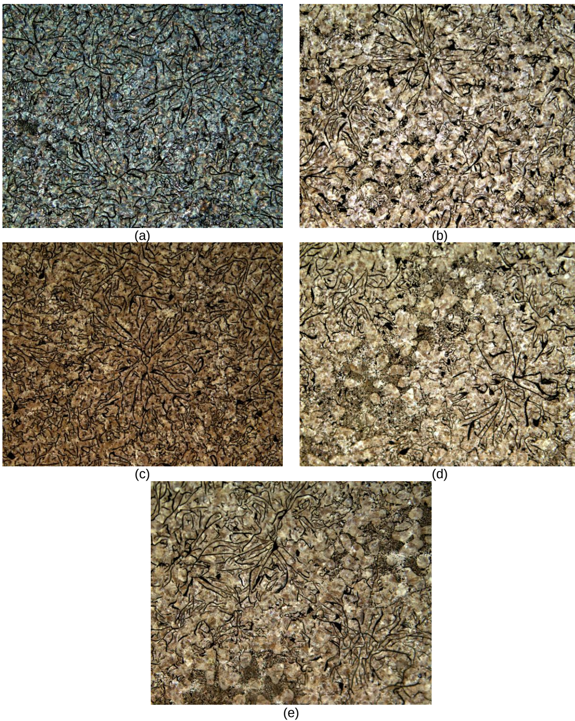
Figura 76 – Microscopia óptica, aumento de 100x, ataque com nital a 2%: a) microestrutura de amostra com adição de 0,2% Pb; b) microestrutura de amostra com adição de 0,4% Pb; c) microestrutura de amostra com adição de 0,5% Pb; d) microestrutura de amostra com adição de 0,8% Pb; e e) microestrutura de amostra com adição de 1,0% Pb.
