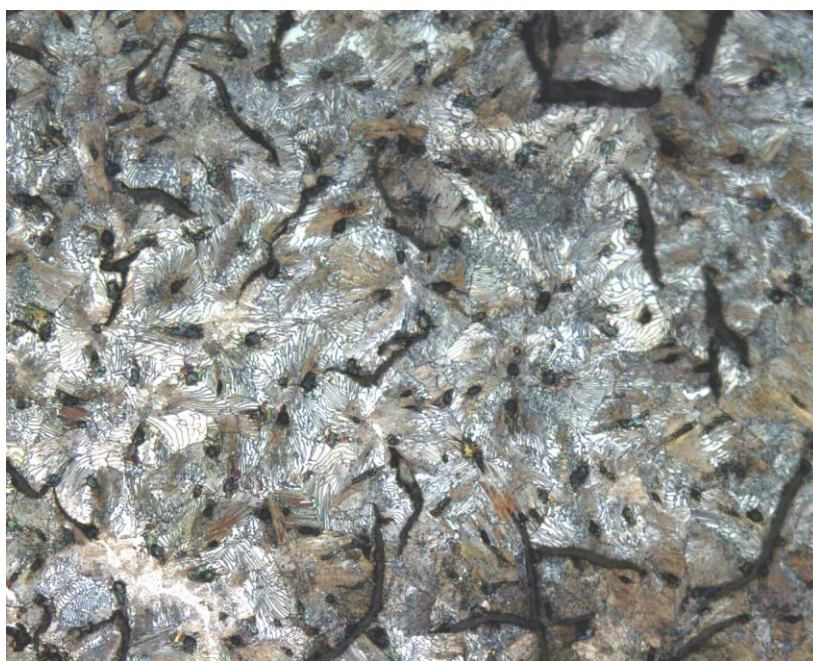
Figura 78 – Microestrutura de amostra com adição de 0,4% Sn. Microscopia óptica, aumento de 500x, ataque com nital a 2%.
