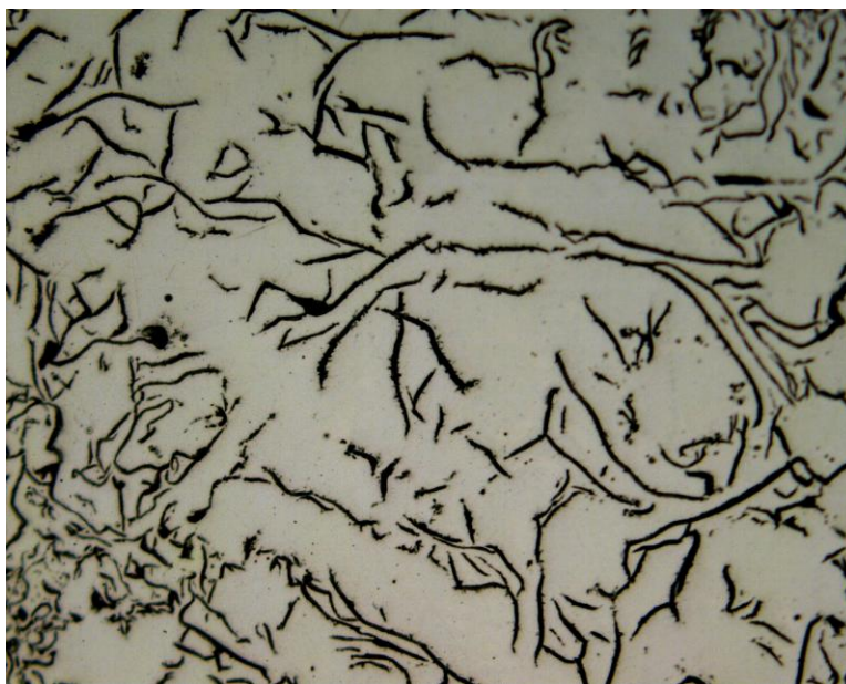
Figura 73 – Microestrutura de amostra com adição de 1,0% Pb. Microscopia óptica, aumento de 200x, sem ataque.
