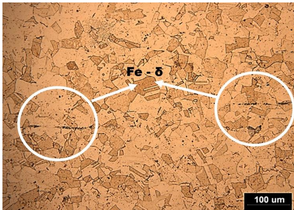
Figura 20 – Micrografia do aço AISI 316L na direção normal à laminação. Ataque: Carpenter; tempo de imersão 25 a 30 segundos; Temperatura de recristalização: 1100 °C; tempo: 30 minutos
