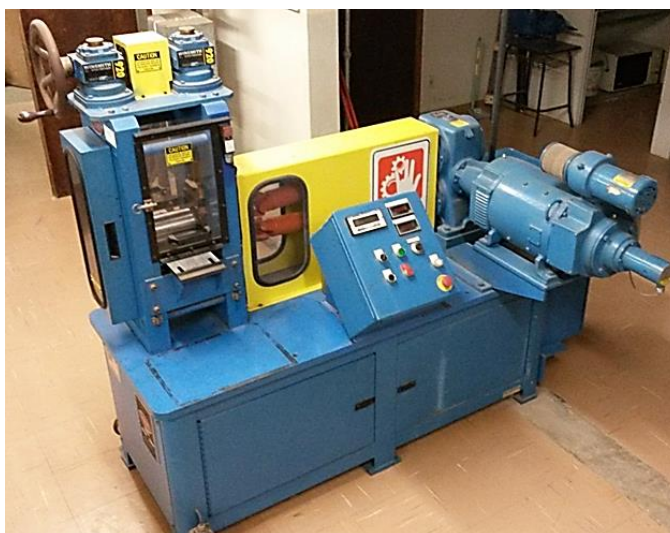
Figura 14 – Laminador Fenn, instalado no Laboratório do Departamento de Engenharia de Materiais da Universidade Estadual de Ponta Grossa, PR
