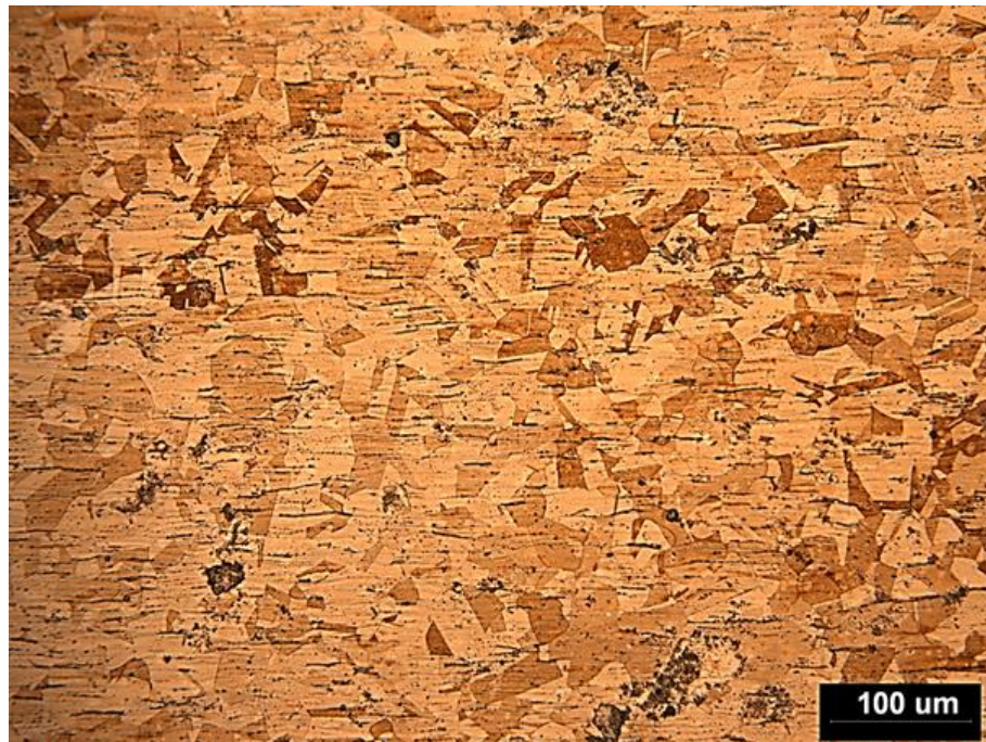
Figura 21 – Micrografia do aço AISI 316L na direção longitudinal à laminação. Ataque: Carpenter; tempo de imersão 25 a 30 segundos; Temperatura de recozimento: 1100 °C durante 30 minutos
