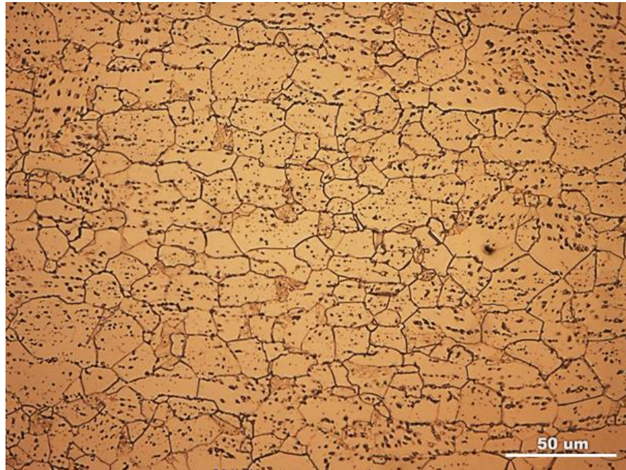
Figura 25 – Micrografia do aço AISI 430 na direção longitudinal à laminação. Ataque: Vilella (modificado); tempo de imersão 1 a 1,5 minutos; Temperatura de recozimento: 790 °C durante 30 minutos
