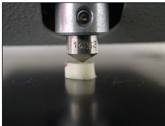
Figura 31- Momento da indentação com o diamante Vickers
