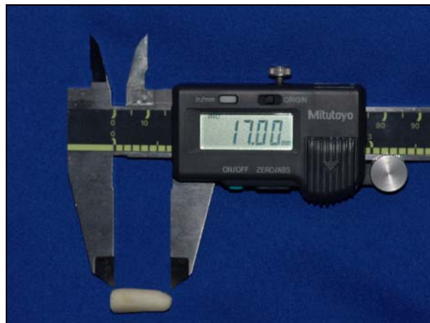
Figura 3- Paquímetro digital demonstrando o comprimento das raízes
