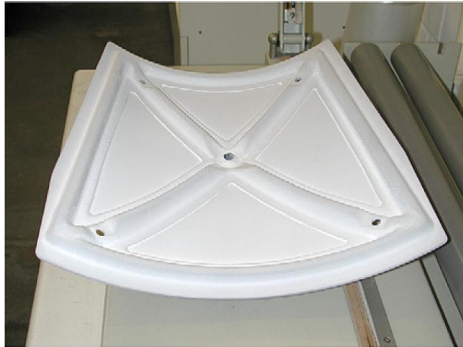
FIGURA 3.2 - Revestimento de mulita em painel de veículos espaciais.
