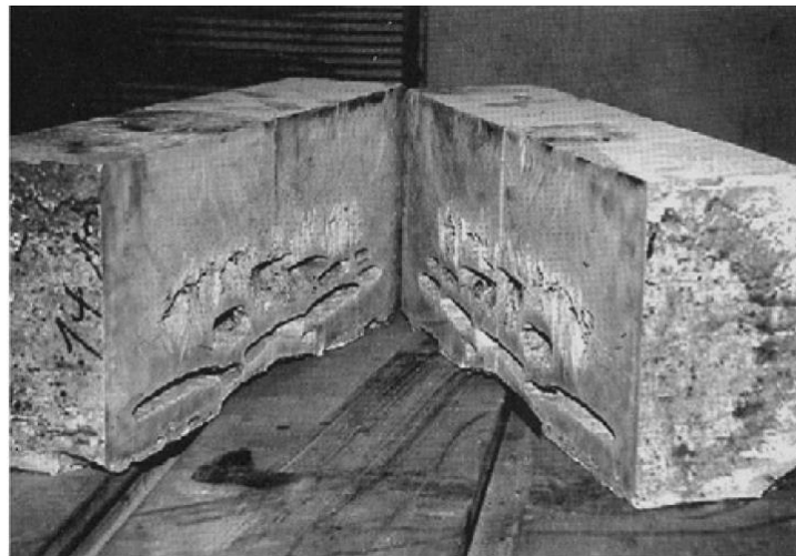
FIGURA 3.1: Tijolo refratário de mulita fundida.
