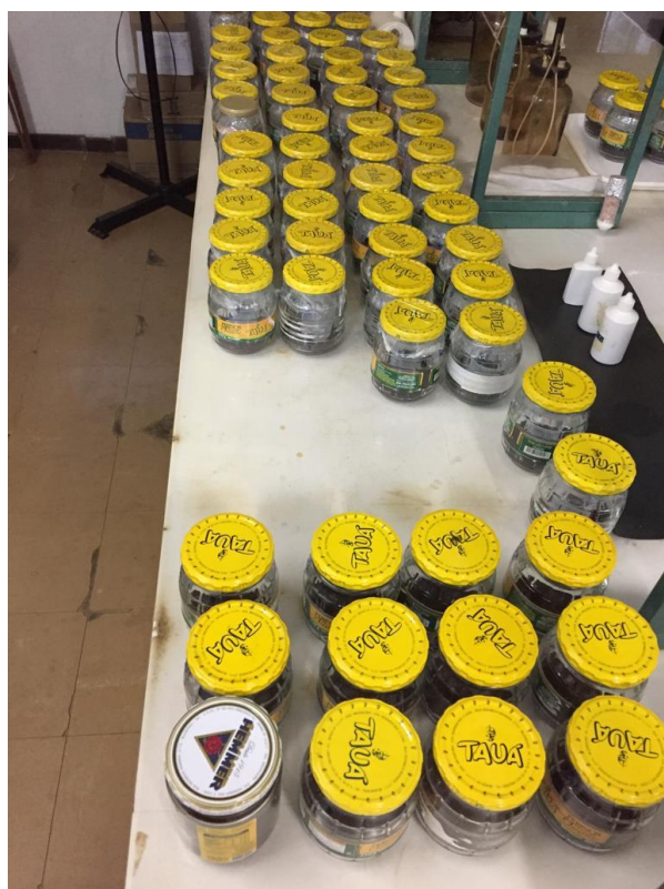
Foto 5 e 6 – A Direita análise de nitrato e amônio no solo, amostras 2019-20. A Esquerda potes em análise da respiração basal do solo, amostras 2019-20.
