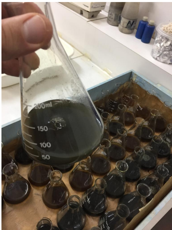
Foto 3 e 4 – A Direita, foto do extrato da digestão para análise de NBM, amostras 2019-20. A Esquerda, foto da titulação do carbono no solo, amostras verão 2019-20.
