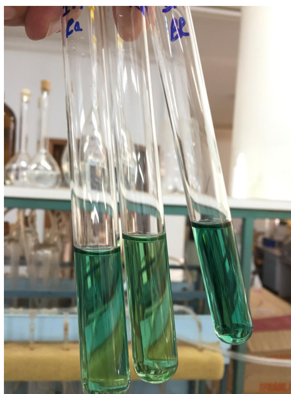
Foto 5 e 6 – A Direita análise de nitrato e amônio no solo, amostras 2019-20. A Esquerda potes em análise da respiração basal do solo, amostras 2019-20.
