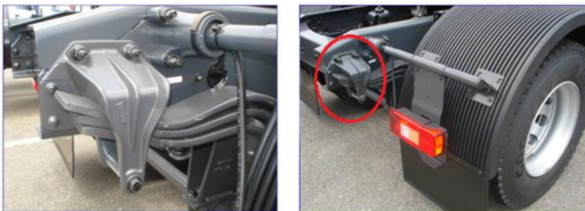
Figura 3.18 – Exemplo de aplicação do ADI em suportes de feixes de molas para caminhões.
