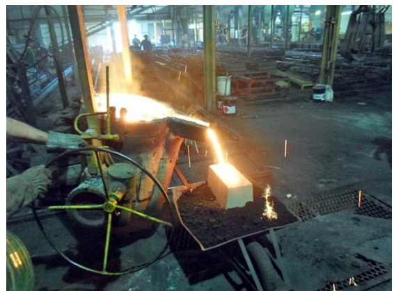
Figura 4.1: (a) Dimensões dos blocos Y utilizados para a confecção dos corpos de prova; e (b) vazamento da liga de nodular no molde de bloco Y, por meio de panela basculante.
