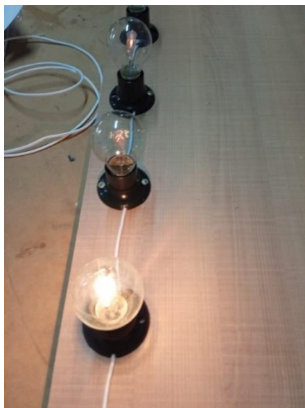
Figura 4 - Modelos de circuito em série apresentados aos alunos
