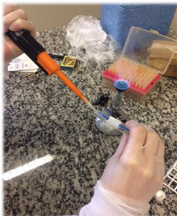
Figura 5 - Introdução da ponta de pipeta no interior do tubo para coleta de 100 \mu L da solução.
