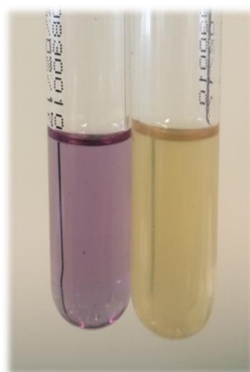
Figura 13 - Teste do MTS: tubo roxo representando resultado negativo e tubo amarelo representando resultado positivo.
