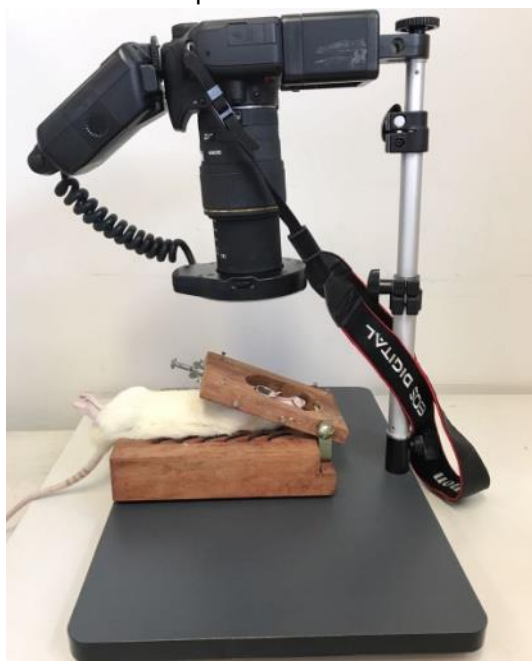
FIGURA 10 - Posicionamento dos animais em maca estabilizadora e utilização de mesa estativa para obtenção de fotografias padronizadas
