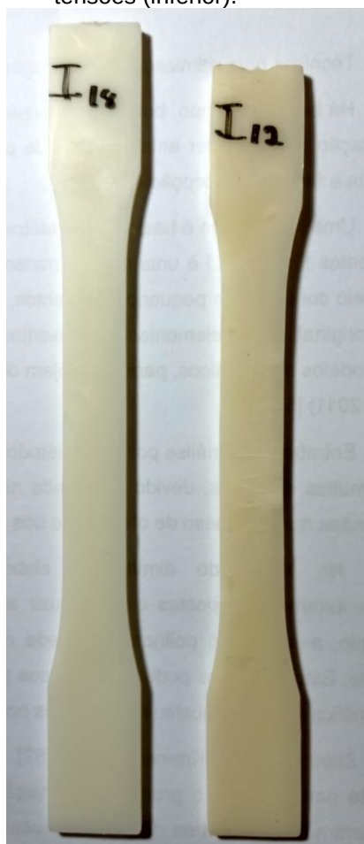
Figura 50 – Corpos de prova da condição I, sem alívio de tensões (superior) e com alívio de tensões (inferior).
