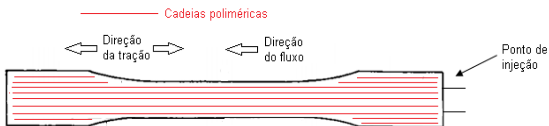
Figura 24 – Corpo de prova de tração utilizado. As linhas vermelhas representam as cadeias poliméricas.
