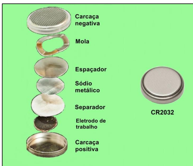
Figura 32: Componentes da bateria CR2032.
