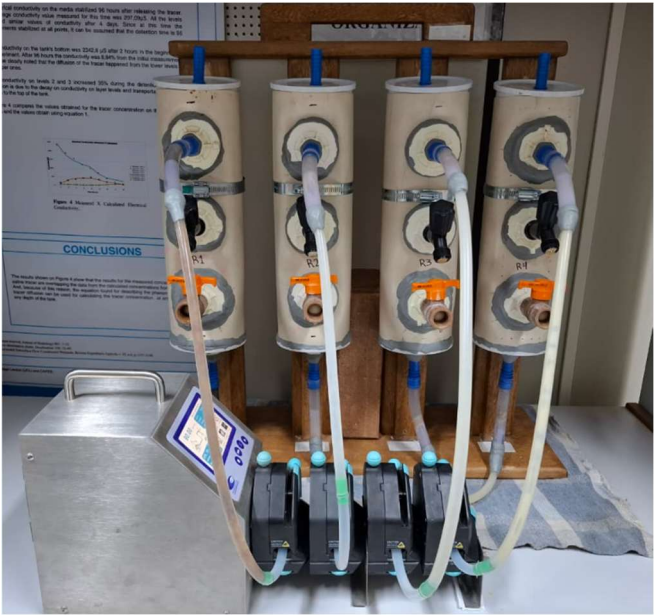
Figura 14: Sistema completo dos reatores em operação (da esquerda para direita: R1, R2, R3 e R4)
