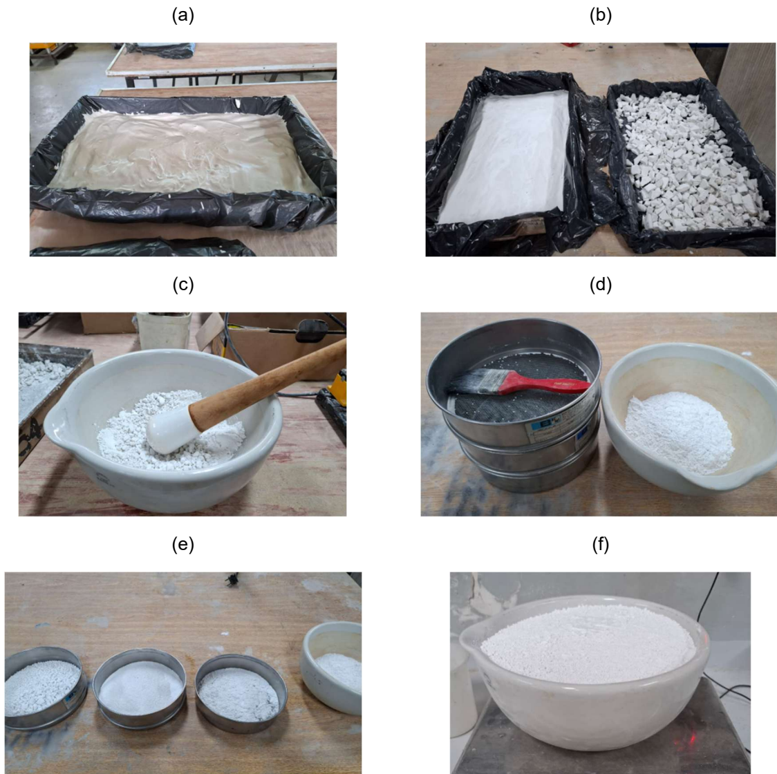
a) Hidratação do gesso; b) Gesso após 7 dias de cura; c) Maceração do gesso; d) Sistema de peneiramento do gesso; e) Gesso peneirado; f) Pó de gesso peneirado
