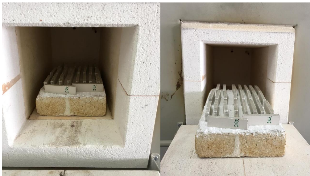
Figura 8 – Posicionamento dos corpos-de-provas cerâmicos na mufla para sinterização
