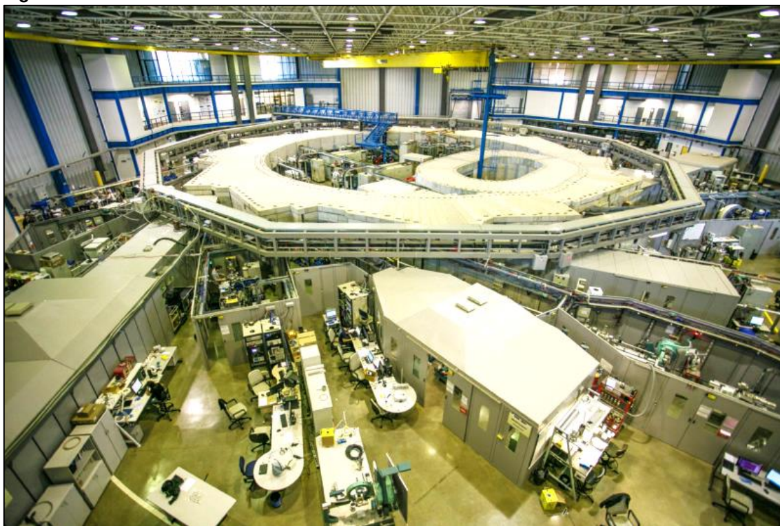
Figura 15. Anel síncrotron UVX. Atualmente estão instaladas 20 linhas de luz.
