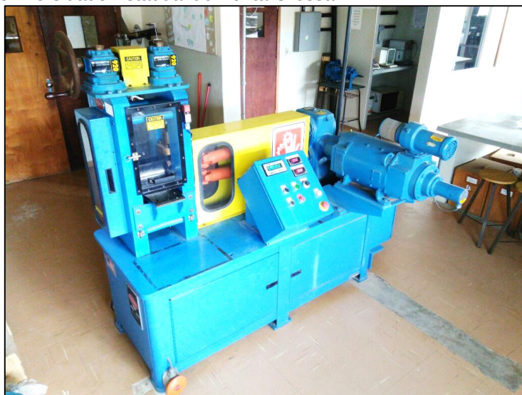
Figura 17. Laminador de laboratório Fenn, instalado no laboratório do Departamento de Engenharia de Materiais da Universidade Estadual de Ponta Grossa.
