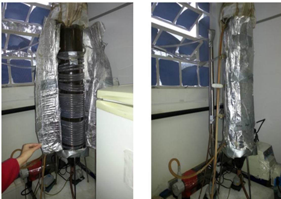
Figura 9 – Sistema para manutenção da temperatura interna do reator.
