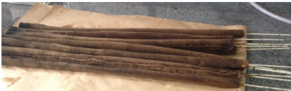
Figura 6 – Espumas de poliuretano utilizadas como suporte para a biomassa
