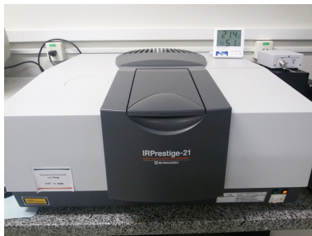
Figura 3: Espectrofotômetro MIR, marca Shimadzu, modelo IRPrestige-21, utilizado para leituras de amostras de folhas.
