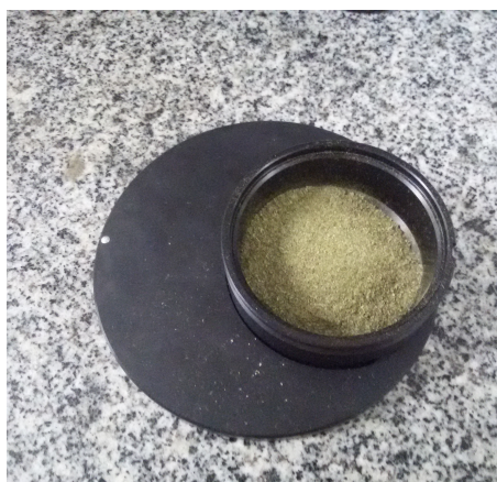
Figura 2: Amostra com 40 ml de folha de soja no acessório SmallCup do espectrofotômetro NIR.
