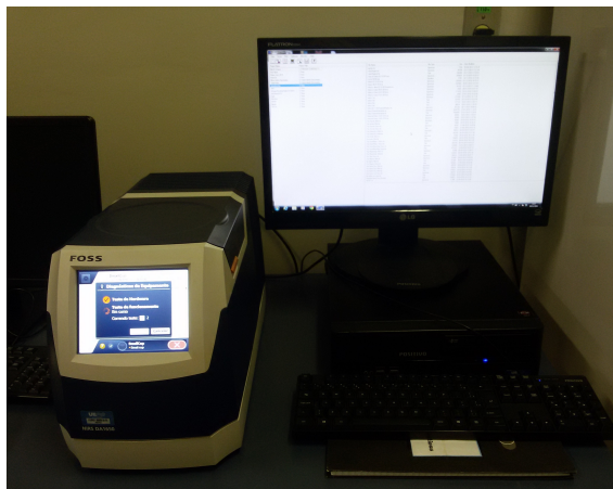
Figura 1: Espectrofotômetro NIR, marca FOSS, modelo DA 1650, onde foram lidas as amostras de folhas e grãos.
