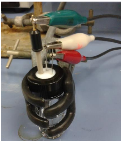
Figura 22: Célula utilizada para os experimentos de voltametria ac de alta amplitude acoplada com transformada de Fourier
