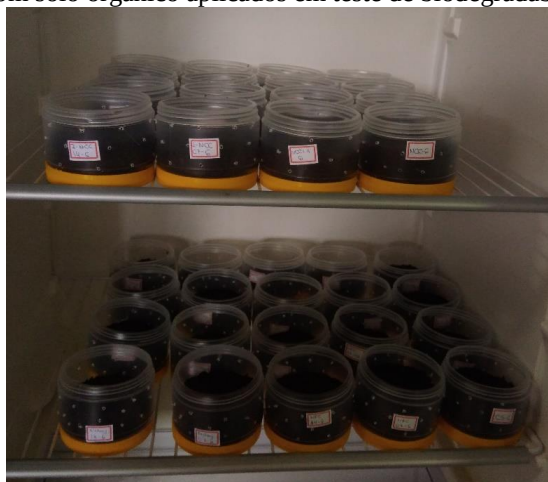
Figura 2.2: Recipientes com solo orgânico aplicados em teste de biodegradabilidade dos filmes
