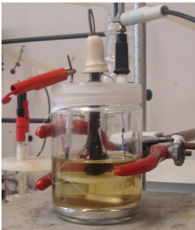
Figura 58: Célula eletroquímica utilizada na preparação do copolímero MB-PPV/DCN-PPV.
