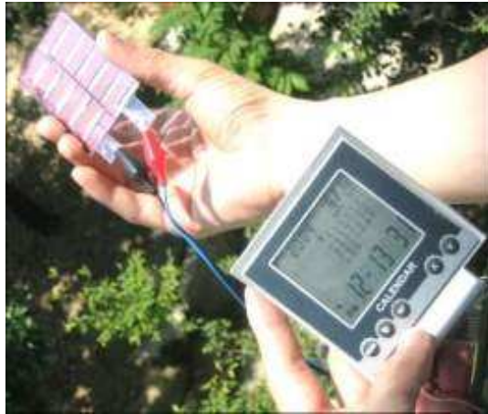
Figura 5: Calendário eletrônico funcionando a partir da energia gerada por uma célula solar. 18
