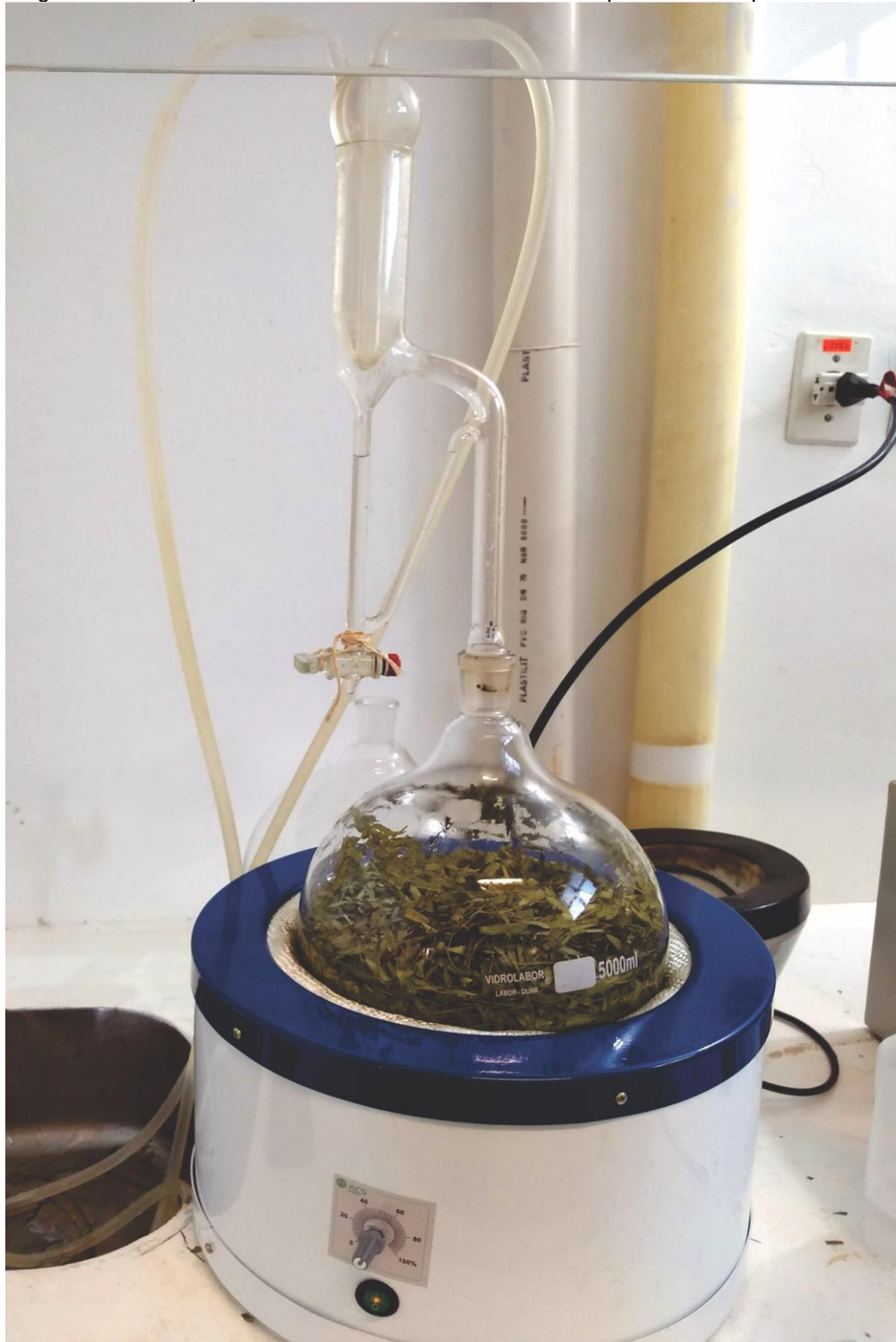
Figura 4 – Extração do óleo essencial de Schinus molle por meio do aparato Clevenger
