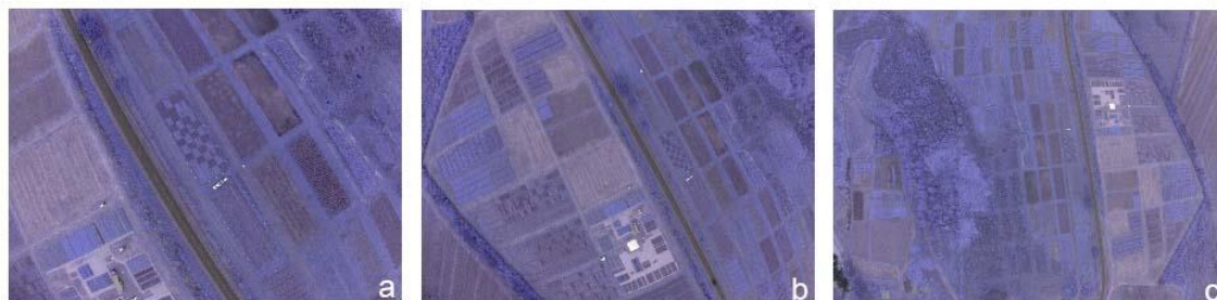
Figura 45 - Imagens capturadas em diferentes resoluções: GSD 5 cm/pixel (a), GSD 10 cm/pixel (b) e GSD 15 cm/pixel (c).
