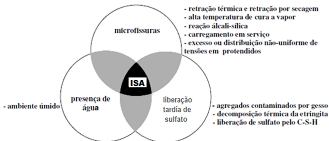
Figura 7 – Fatores necessários para que ocorra o fenômeno de ataque interno por sulfatos
