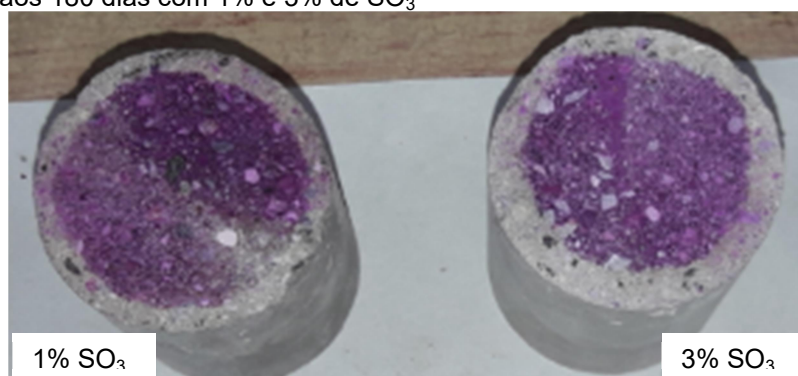
Figura 65 - Corpo de prova e a camada onde ocorreu o processo de carbonatação – tratamento com ARC aos 180 dias com 1% e 3% de \text{SO}_3
