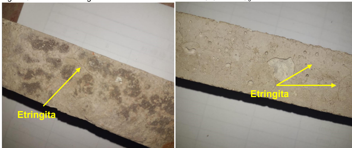
Figura 82 – Barras de argamassa do tratamento ARM-DZO-3% de \text{SO}_3
